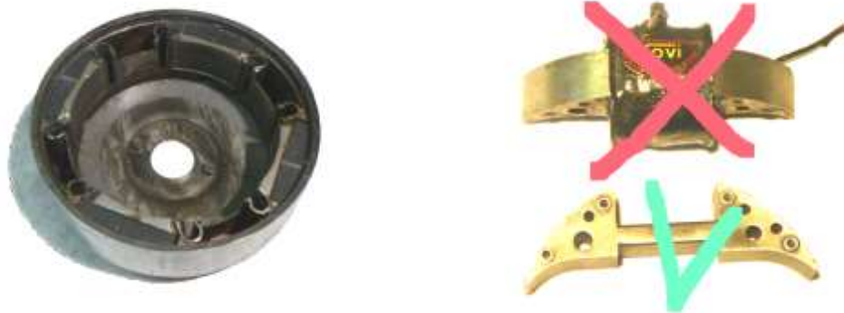
Afb. 2: Vliegwiel met magneten en hoogspanningspoel uit 1950 met bruikbare kern.
