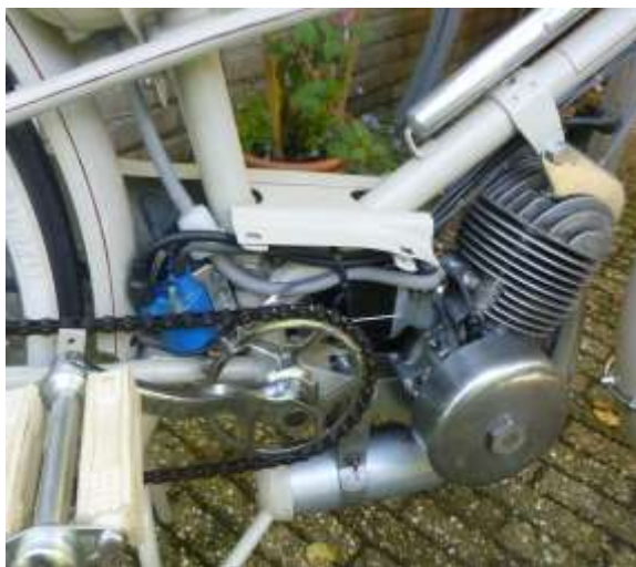
Afb. 17: Plaatsing van de bobine achter de zadelbuis onder de motorschermen.
