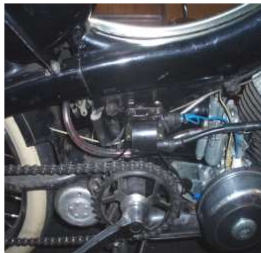
Afb. 16: Bij de Fiets-O-matic BG44 wordt meestal gekozen voor montage boven de trapas en tegen de rechterzijde van het frame.
