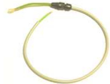
Afb. 7: Kabel van verbindingspilaar naar bobine.
